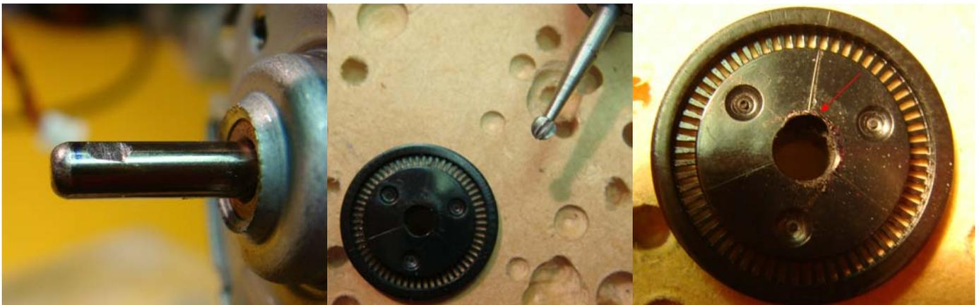
Mit einem Marker die Position des Sensorrades auf der Motorwelle kennzeichnen und danach das Sensorrad abziehen.
